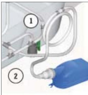
1. Pour éviter un retour d'eau dans le blower, installez toujours une double boucle d'air et un clapet anti-retour, ou deux clapets anti-retour, côté eau de la boucle d'air pour que le tuyau passe deux fois au dessus du niveau de l'eau.
