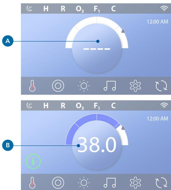
Quand le spa est branché, 4 traits (A) apparaissent dans l'affichage de la température de l'eau pour une minute. Les traits indiquent que le spa vérifie la température de l'eau. Une fois que les pompes ont fonctionné 1 minute, les traits disparaissent et la température de l'eau est affichée (B). Les traits peuvent réapparaître après que la pompe n'ait pas fonctionné pendant une heure.
